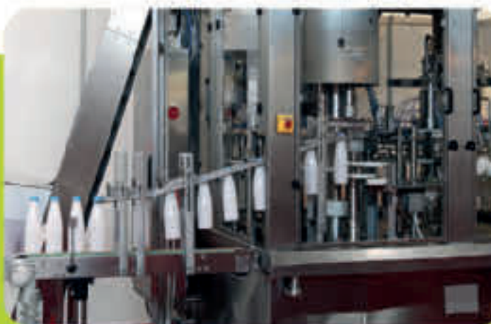
Lubrification de sertisseurs et de conserveurs par suspension de bouteilles PET en IAA.
