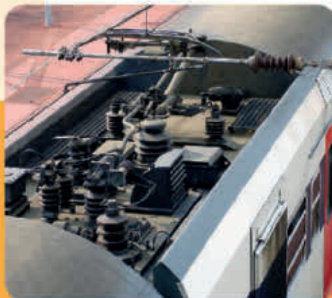
Lubrification dynamique, sous HT, de pantographes.
