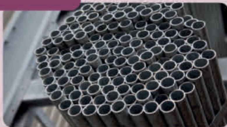
Protection anti-corrosion de tubes en boîtes, par immersion.
